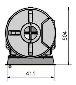
Verbrennungsluftdurchmesser = 125 mm Position seitlich, hinten, oder unten wählbar
